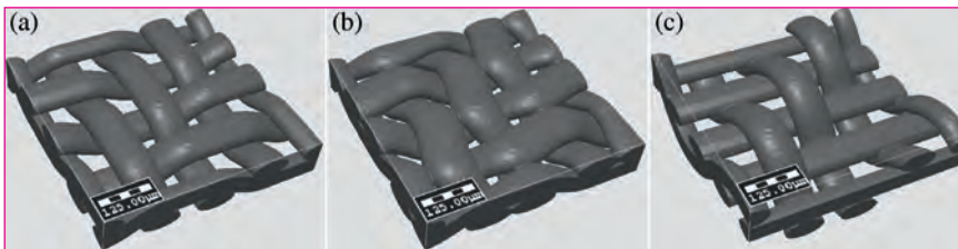
Abb. 2: Virtuell generiertes KÖpergewebe (2/2-Bindung) mit h_{wa} = h_{we} = 50\mu\text{m} , w_{wa} = w_{we} = 100\mu\text{m} , p_{wa} = p_{we} = 150\mu\text{m} . (a): Ohne Formvariationen. (b): Mit Verbreiterung und lateraler Deformation b_{wa} = b_{we} = 0.2 und d_{wa} = d_{we} = 15\mu\text{m} . (c): Mit Steifigkeit und Kröpfung s = 0.5 und c = 1 .
